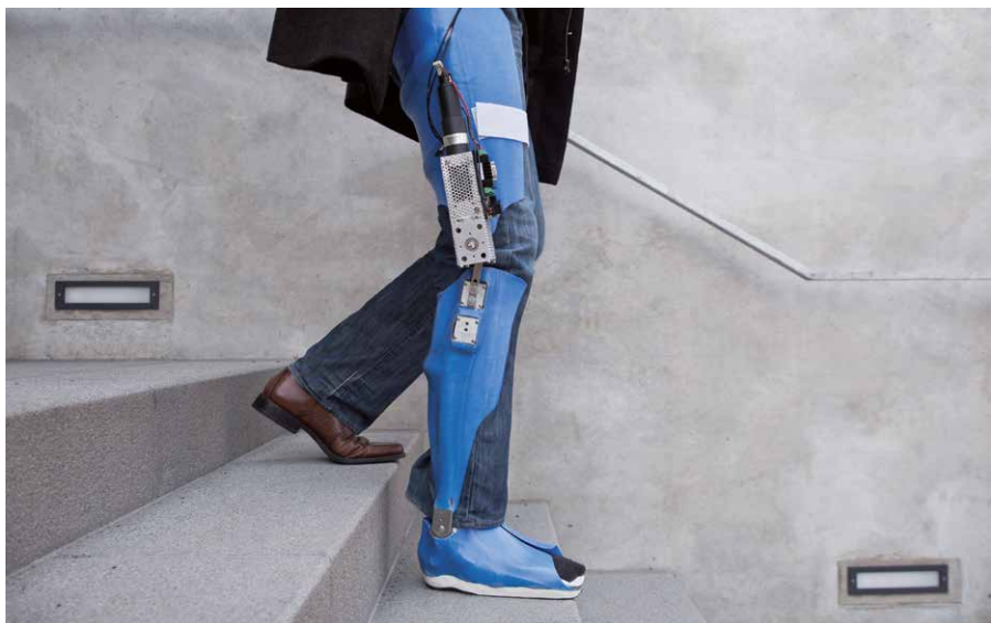
Treppenlaufen leicht gemacht: Ein Minimotor im Exoskelett unterstützt die Muskulatur.
